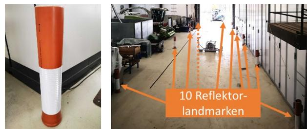
Abbildung 2. Links: Reflektorlandmarke. Rechts: Versuchshalle des IMN als Versuchsfeld
