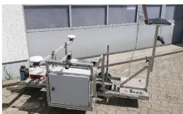
Abbildung 1. Holonomer Versuchsroboter mit SICK Nav 350 und GNSS-Antennen zur Lokalisierung
