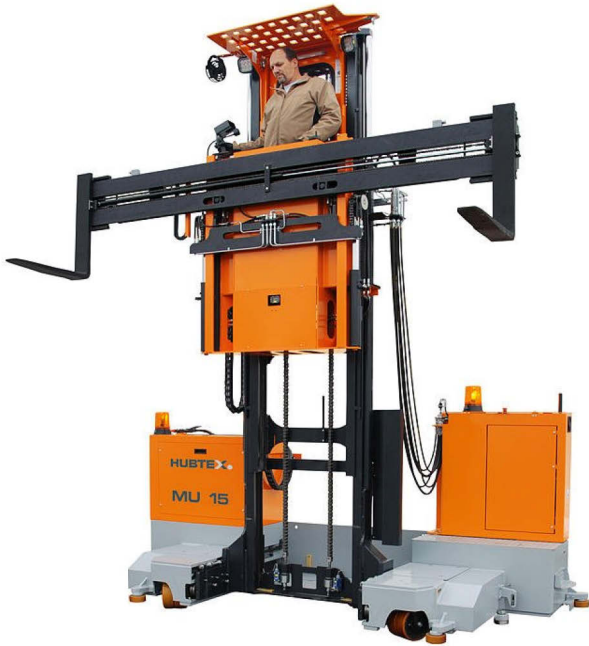
Abbildung 5: Langgutkommissionierer Hubtex MU 15 (Quelle: HUBTEX)
