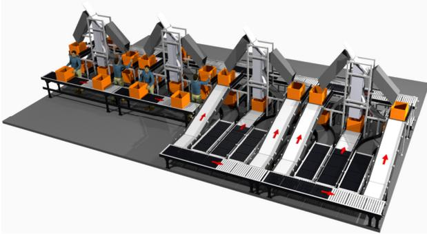
Abbildung 19. Gegenüberstellung von manuell- und automatisch beschickten Endstellenkonzepten
