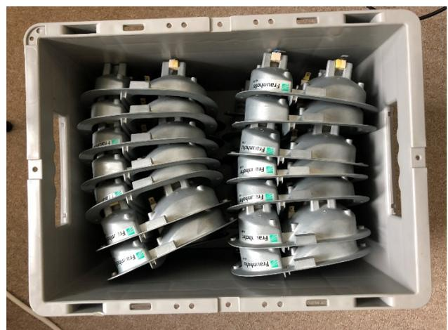
Abbildung 3: Metallgussteile, die als Füllmaterial für die Ladungsträger für die Füllstandserkenkung verwendet wurden
